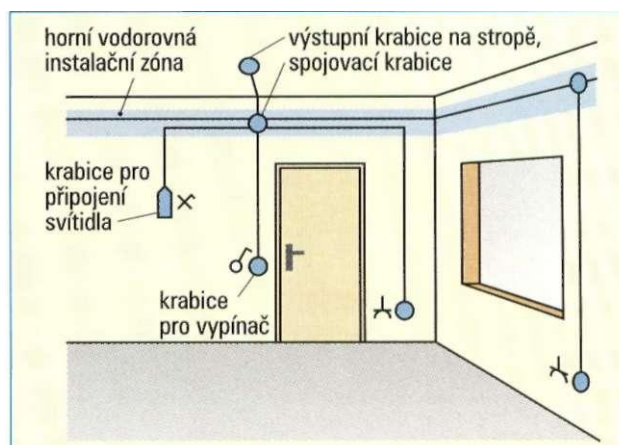
Obr. 1: Elektrická instalace se spojovacími krabicemi
