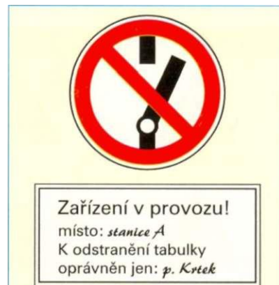
Obr. 2: Zákazová značka „nezapínat“ s přídatným štítkem
