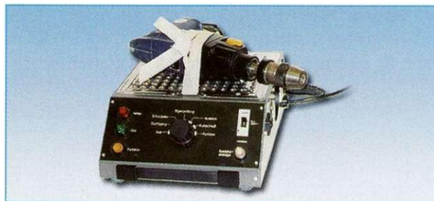
Obr. 1: Měření izolačního odporu u přístrojů třídy ochrany II
