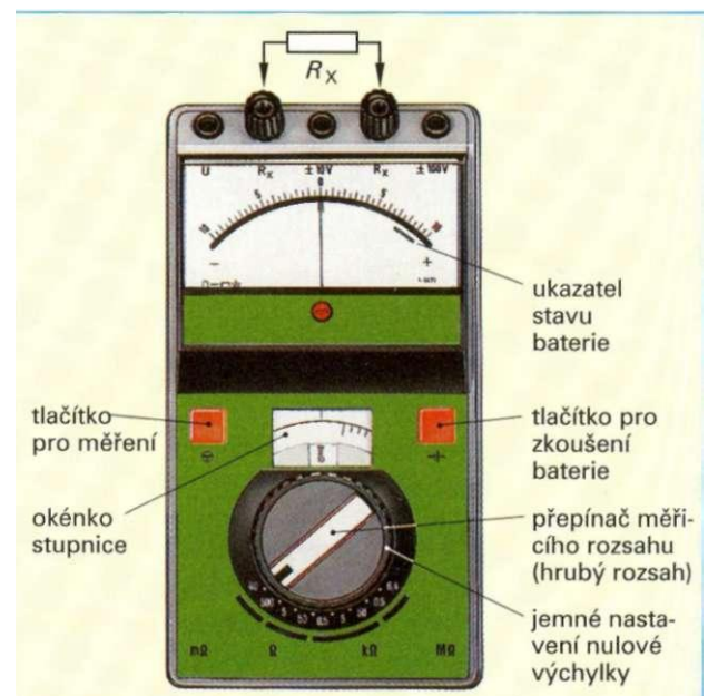
Obr. 4: Odporový měřicí můstek
