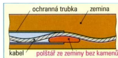
Obr. 2: Ochrana kabelu na přechodu do ochranné trubky
