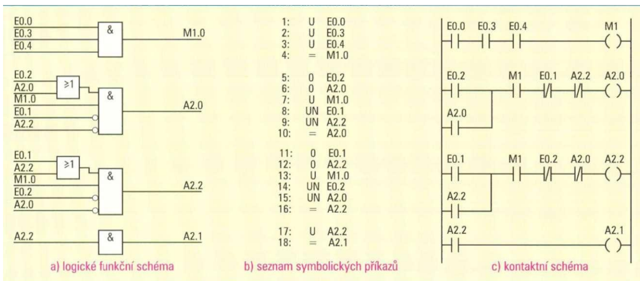
Obr. 2: Porovnání popisů ovládání Dahlanderova motoru
