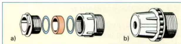
Obr. 1: Konstrukce a) dvoudílné šroubovací průchodky b) jednodílné utěšňovací průchodky
