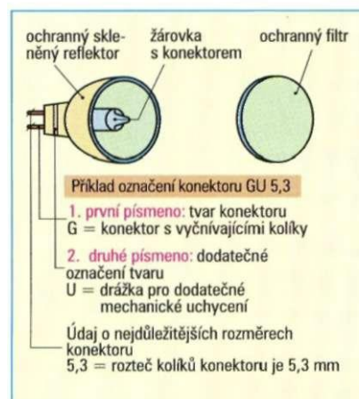
Obr. 2: Halogenová žárovka s reflektorem a ochranným filtrem
