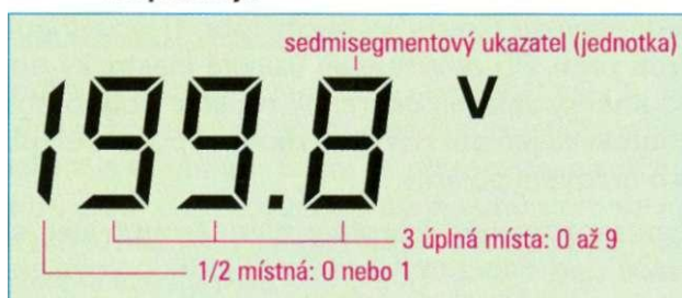
Obr. 2: Segmentové zobrazení, 3 1/2 místné
