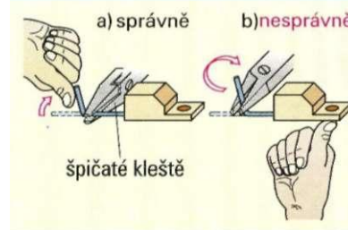
Obr. 2: Ohýbání vývodů polovodičových součástek
