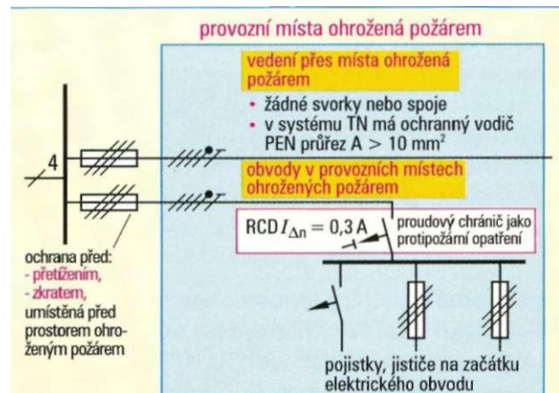
Obr. 3: Nadproudová ochrana v místech ohrožených požárem
